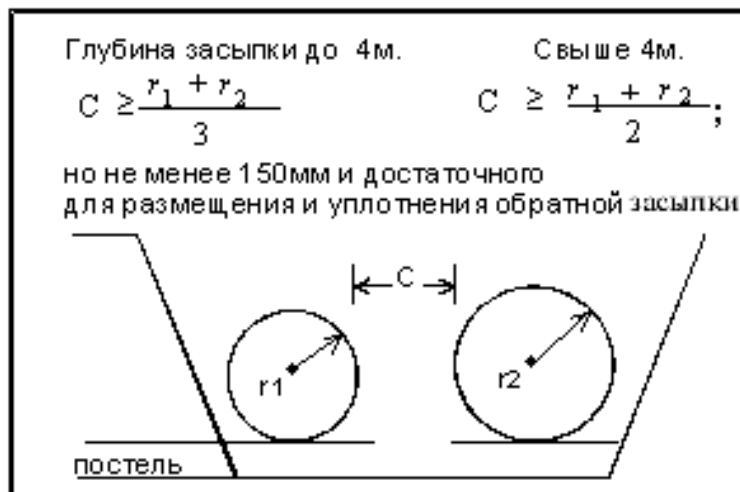
Рисунок 14.1 - Расстояние между трубами в общей траншее
