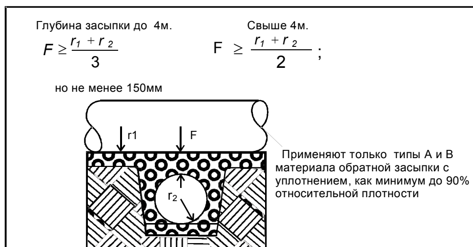
Рисунок 14.2 - Пересечение трубопроводов
