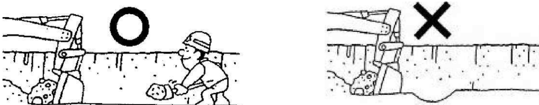
Рис.53. Разработка грунта в траншеи
