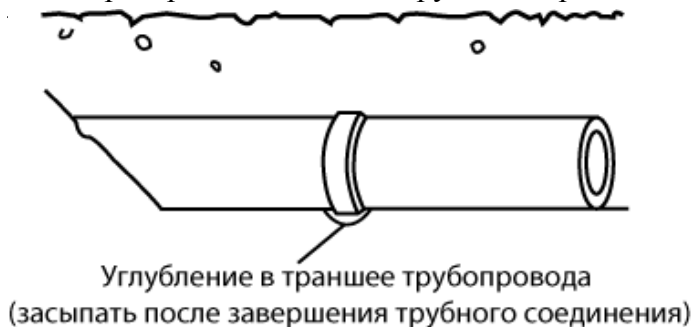
а. Правильно выполненная подсыпка
