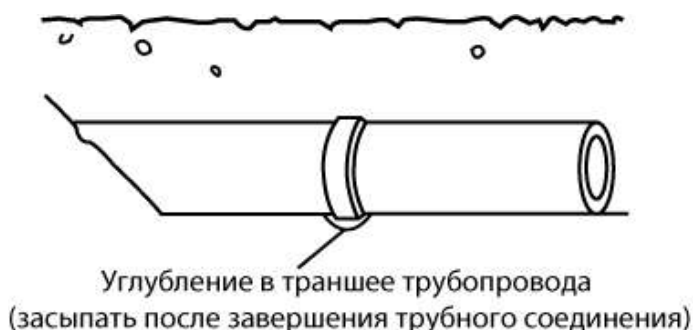
а. Правильно выполненная подсыпка
