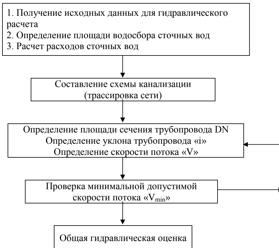
Рис. 1 Алгоритм гидравлического расчета.
