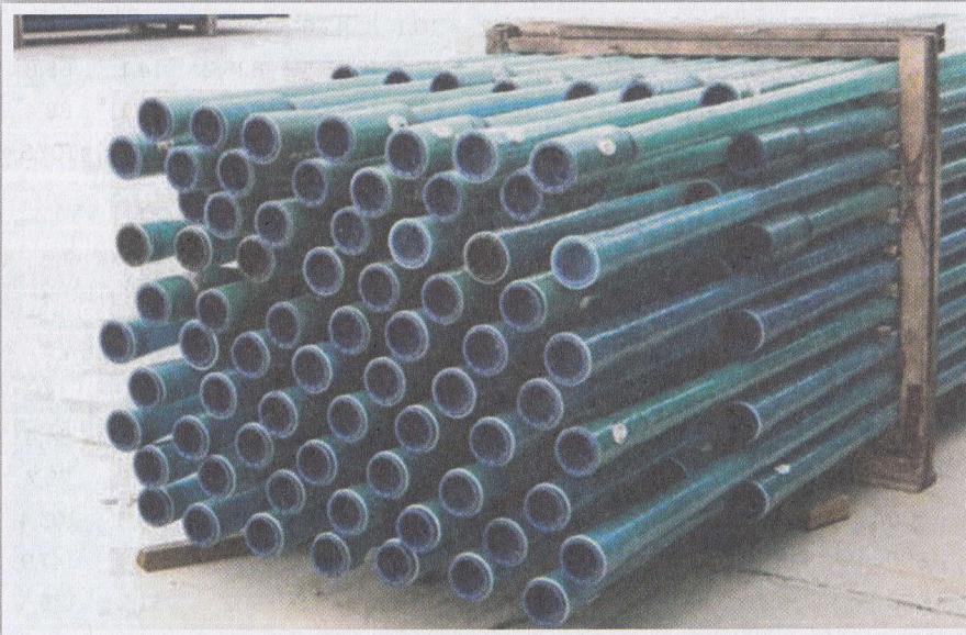
Стекловолоконные трубы DN 100 мм PN6 МПа с раструбно-нипельно шиповым резьбовым соединением Назначение: нагнетательные линии м.р. Балгинбаева, Атырауская область, РК.
