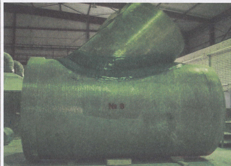
Стекловолоконный тройник DN2600x2000 мм с углом ответвления 45°, PN 0,6 МПа SN7500 Н/м². Назначение: Циркуляционные водопроводы Невинномысской ГРЭС, г. Пятигорск, РФ.
