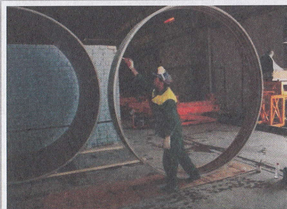
Фрагмент изготовления стекловолоконной муфты DN2600 мм PN1 МПа SN7500 Н/м²
