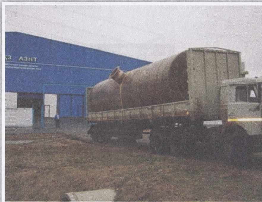
Стекловолоконная ёмкость DN2600 V-75 м³. Назначение: хранение питьевой воды
