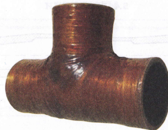
Фрагмент равнопроходного тройника DN100 мм PN 7,5 МПа с резьбовым соединением.
