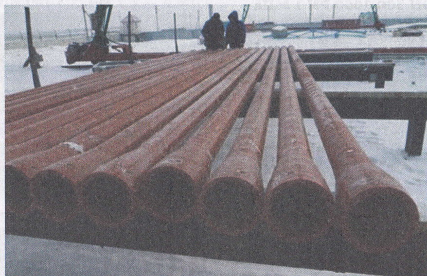
Стекловолоконные трубы DN 100 мм PN2,5 МПа соединение «Кей-Лок». Назначение: выкидные линии м.р Жанаталап, Атырауская область, РК.
