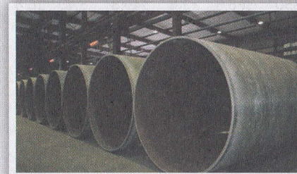
DN2600 мм, PN 0,6 МПа, SN 7500 Н/м² Скорость потока 4 м/с, объём 17 м³/с Назначение: Циркуляционные водо- проводы Невинномысской ГРЭС, г. Пятигорск, РФ.
