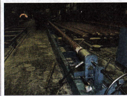
Стенд гидроиспытания труб DN 80-200
