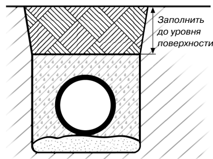
Рис. 4.5. Окончательная засыпка траншеи
